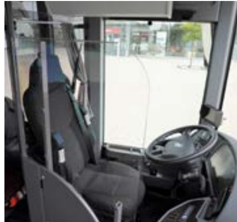
Mamparas para el puesto de conducción
