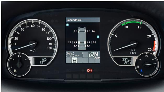
A pressão correta dos pneus contribui para a segurança de condução e para uma redução significativa do consumo de combustível. Uma pressão de enchimento dos pneus ajustada em 0,5 bar demasiado baixa pode aumentar o consumo de combustível em até 5%. O sistema eletrónico da roda está posicionado no lado interior da jante na válvula. Os sensores registam os dados relevantes para a pressão dos pneus e transmitem-nos ao instrumento indicador.
