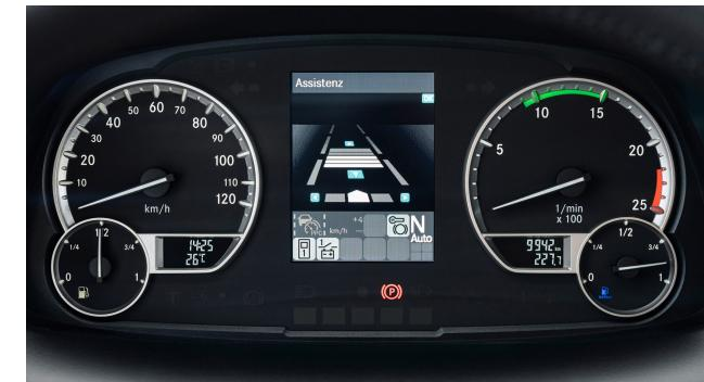
O Active Drive Assist 2 apoia o condutorativamente na manutenção de distâncias e na manutenção da faixa de rodagem, através da combinação de diversos sistemas de assistência. O sistema pode travar, acelerar e manter o veículo na faixa de rodagem através de movimentos ativos na direção. Para o efeito, alia as funções de cada sistema de uma forma única, permitindo assim uma condução semiautomatizada já hoje em dia em todas as gamas de velocidade.
