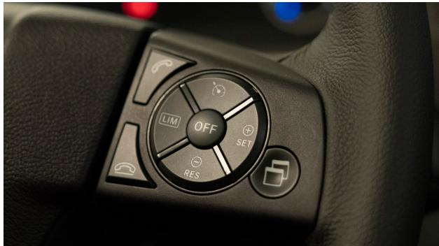
O Adaptive Cruise Control (ART) com Active Brake Assist 6 (ABA 6) alivia o condutor, mantendo automaticamente uma distância constante, definida pelo condutor, em relação ao veículo da frente, com base em medições constantes. O ABA 6 apoia adicionalmente o condutor em caso de colisão iminente com objetos parados, objetos em movimento e peões em movimento.
