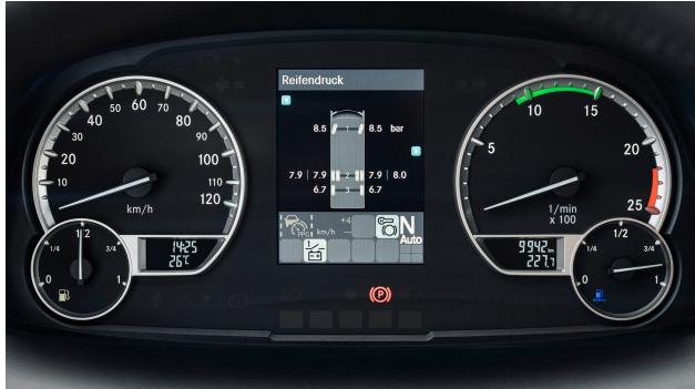
La presión correcta de los neumáticos contribuye a la seguridad de la marcha y a reducir significativamente el consumo de combustible. Basta con que la presión de los neumáticos sea 0,5 bar demasiado baja para aumentar el consumo de combustible hasta en un 5 %. La electrónica de la rueda se coloca en la cara interior de cada llanta, sobre la válvula. Los sensores registran los datos relativos a la presión de los neumáticos y los transmiten al indicador.
