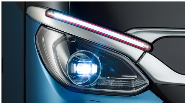
Las luces de cruce y largas tienen un gran rendimiento luminoso gracias a los faros LED integrados, que consumen además mucha menos energía que los faros convencionales. Estos faros iluminan la calzada con una gran amplitud y precisión. Otro factor que refuerza la seguridad es que la temperatura de la luz es similar a la luz diurna y provoca menos cansancio a los ojos del conductor. Los faros LED convencen por su larga vida útil y su baja degradación (pérdida gradual de la luminosidad).
