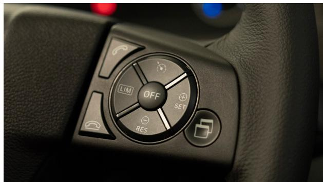
El control de crucero con regulación de distancia (ART) con Asistente Activo de Frenado 6 (ABA 6) ayuda al conductor manteniendo automáticamente una distancia constante, definida por el conductor, respecto al vehículo que circula delante, basándose en mediciones constantes. Además, el ABA 6 asiste al conductor en caso de una posible colisión con objetos detenidos, objetos en movimiento y peatones en movimiento.
