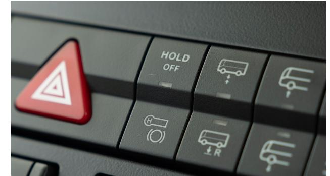
El freno electrónico con función Hold combina un manejo más fácil, mayor confort y una mayor seguridad. Con el autobús parado, al presionar el pedal de freno por encima de cierto punto, el vehículo queda retenido por el freno de servicio; al iniciar la marcha, el freno se libera de nuevo automáticamente. Esta función se puede desactivar con un pulsador.
