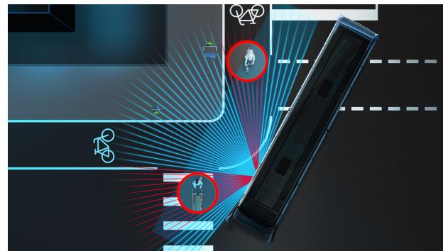
El Sideguard Assist 2 es un sistema de asistencia de seguridad que ayuda al conductor continuamente en situaciones críticas de giro a ambos lados con visibilidad potencialmente limitada. El sistema debería ayudar a detectar obstáculos parados o en movimiento al girar o cambiar de carril, a evitar situaciones críticas al avisar al conductor dentro de los límites del sistema o a reducir las consecuencias de un accidente.
