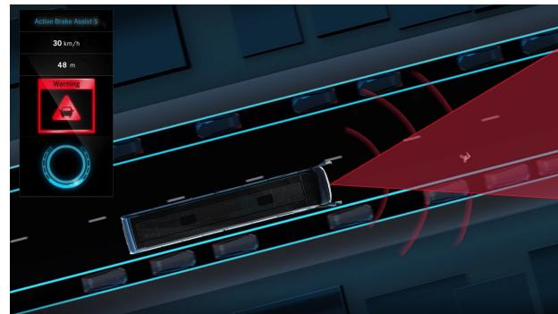
El sistema de asistencia de frenado de emergencia ABA 6 ayuda al conductor en caso de peligro de colisión por alcance con vehículos precedentes o con obstáculos parados mediante un frenado de emergencia iniciado automáticamente. También detecta personas o ciclistas en movimiento o inmóviles delante del vehículo. El sistema reacciona con una advertencia acústica y óptica al conductor, así como con una frenada parcial o en caso necesario, con una frenada total.
