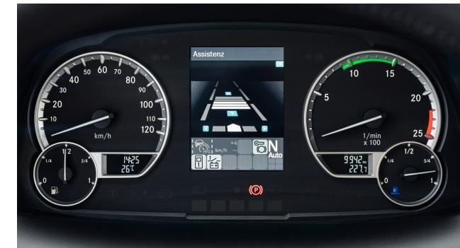
El Active Drive Assist 2 ayuda activamente al conductor a mantener la distancia y el carril mediante la combinación de distintos sistemas de asistencia. El sistema es capaz de frenar y acelerar el vehículo y mantenerlo en su carril mediante la intervención activa en la dirección. Para ello, combina de forma magistral las funciones de los distintos sistemas y hace realidad hoy una conducción semiautomatizada en todos los rangos de velocidad.
