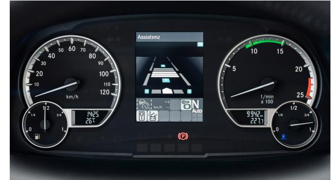
Mediante un sistema de cámara situado detrás del parabrisas, el asistente de carril (SPA) detecta la salida accidental del carril marcado. Tan pronto como el vehículo rebasa la señalización horizontal, se advierte de ello al conductor mediante una vibración perceptible del lado correspondiente de la superficie del asiento del conductor.
