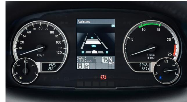
L'Active Drive Assist 2 coadiuva il conducente nel mantenere la distanza e la corsia, con la combinazione di diversi sistemi di assistenza attivi. Il sistema può frenare il veicolo, accelerare e tenerlo nella corsia grazie a movimenti attivi dello sterzo. Inoltre collega le funzioni dei singoli sistemi in modo unico consentendo già oggi la guida parzialmente automatizzata in tutte le fasce di velocità.
