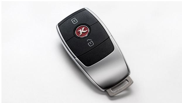
Avviamento del veicolo senza inserire la chiave nel blocchetto di accensione: il sistema di accesso senza chiave Keyless-Start (Sistema di autorizzazione alla marcia 4 FBS 4) lo rende possibile. A questo scopo, la chiave elettronica del veicolo deve trovarsi solo nelle vicinanze della cabina conducente, può anche essere lasciata comodamente nella tasca del conducente. L'avviamento del motore avviene tramite pressione del pulsante di accensione.
