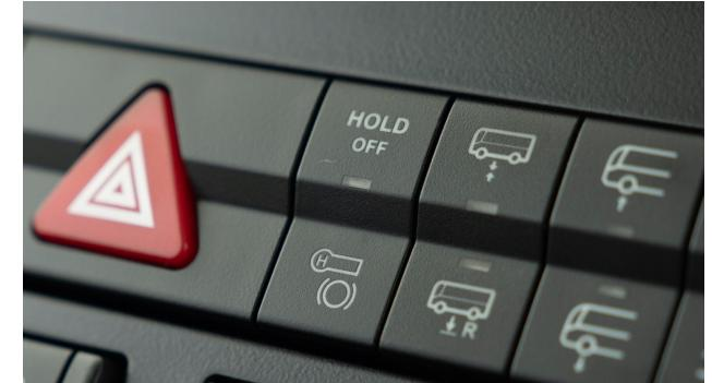
Il freno elettronico con funzione di hold unisce una semplice gestione con maggiore comfort e più sicurezza. In caso di fermata dell'autobus, premendo il pedale del freno oltre un determinato punto, il veicolo viene tenuto dal freno di esercizio e alla partenza il freno viene automaticamente rilasciato. La funzione è disattivabile tramite tasto.
