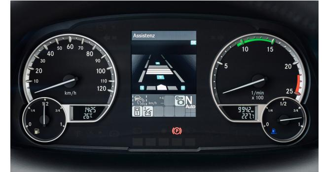
Mit Hilfe eines Kamerasystems hinter der Windschutzscheibe erkennt der Spur-Assistent SPA, wenn das Fahrzeug ungewollt die markierte Spur verlässt. Sobald das Fahrzeug die Markierungslinien überfährt, wird der Fahrer durch ein deutliches Vibrieren auf der entsprechenden Seite der Sitzfläche des Fahrersitzes gewarnt.
