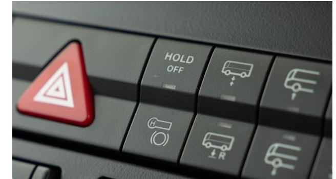
Die elektronische Bremse mit Hold-Funktion vereint einfacheres Handling, mehr Komfort und höhere Sicherheit. Bei Stillstand des Busses wird durch Drücken des Bremspedals über einen bestimmten Punkt das Fahrzeug durch die Betriebsbremse gehalten, beim Anfahren wird die Bremse automatisch wieder gelöst. Die Funktion ist durch einen Taster deaktivierbar.
