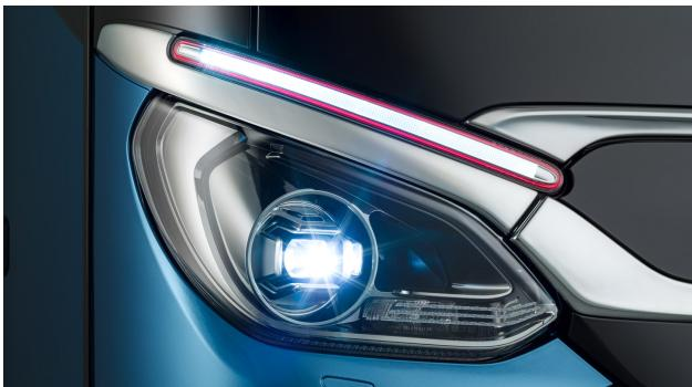
Abblend- und Fernlicht profitieren von der hervorragenden Lichtausbeute der Integral-LED-Scheinwerfer, die gegenüber dem Standardlicht zudem mit deutlich weniger Energie auskommen. Sie leuchten die Fahrbahn breit und präzise aus. Ein weiterer Sicherheitsgewinn ist die Licht-Temperatur, die der von Tageslicht ähnlich ist und die Augen weniger schnell ermüden lässt. Die LED-Leuchten überzeugen durch eine lange Lebensdauer und geringe Degradation (Nachlassen der Leuchtkraft).
