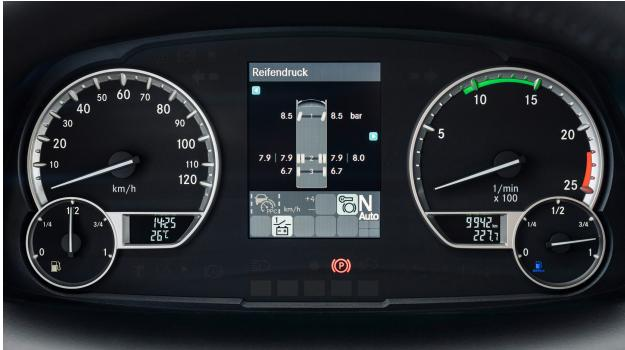
Der richtige Reifenfülldruck trägt zur Fahrsicherheit und deutlich reduzierten Kraftstoffverbrauch bei. Bereits ein um 0,5 bar zu niedrig eingestellter Reifenfülldruck kann den Kraftstoffverbrauch um bis zu 5% erhöhen. Die Radelektronik ist jeweils an der Innenseite der Felge auf dem Ventil positioniert. Die Sensoren erfassen die für den Reifendruck relevanten Daten und leiten sie an das Anzeigegerät weiter.
