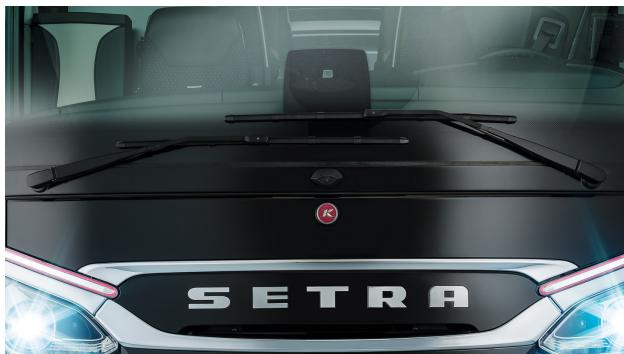
Mit seinem innovativen Profil sorgt der Flachblattwischer dafür, dass das Wischwasser auf der Frontscheibe besonders gleichmäßig verteilt wird. Das erhöht den Komfort, spart Wischwasser und
