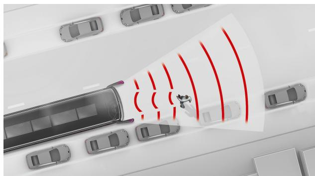
O assistente de travagem de emergência ABA 6 apoia o condutor, iniciando automaticamente a travagem de emergência caso exista um risco iminente de colisão traseira com veículos à frente ou obstáculos estacionários. Também pode reconhecer pessoas em movimento ou paradas e ciclistas na frente do veículo. O sistema pode reage a isto com um aviso acústico e visual para o condutor, bem como inicia automaticamente a travagem parcial ou total.
