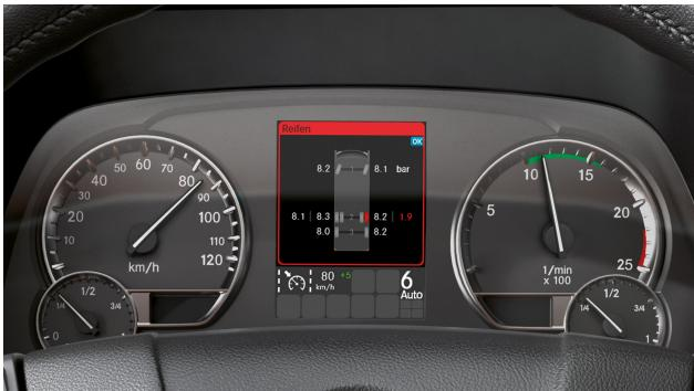
O sistema de controlo da pressão dos pneus com indicação no display multifunções é um sistema de segurança eletrónico, que controla permanentemente a pressão de enchimento de todos os pneus. As perdas de pressão dos pneus são indicadas dentro dos limites do sistema.
