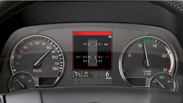
El control de presión de los neumáticos, con indicación en la pantalla multifunción, es un sistema electrónico que controla permanentemente la presión de aire de todos los neumáticos. Las pérdidas de presión se muestran dentro de los límites del sistema.
