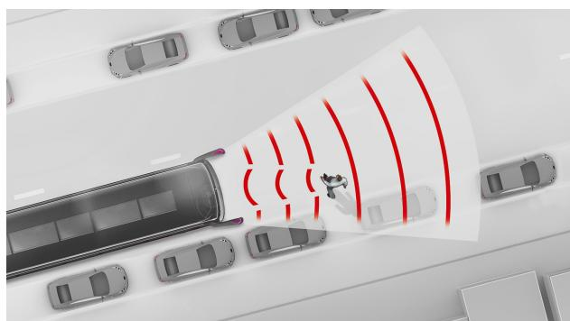
El sistema de asistencia de frenado de emergencia ABA 6 ayuda al conductor en caso de peligro de colisión por alcance con vehículos precedentes o con obstáculos parados mediante un frenado de emergencia iniciado automáticamente. También detecta personas o ciclistas en movimiento o inmóviles delante del vehículo. El sistema reacciona con una advertencia acústica y óptica al conductor, así como con una frenada parcial o en caso necesario, con una frenada total.
