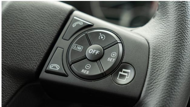
O Adaptive Cruise Control (ART) com Active Brake Assist 6 (ABA 6) alivia o condutor, mantendo automaticamente uma distância constante, definida pelo condutor, em relação ao veículo da frente, com base em medições constantes. O ABA 6 apoia adicionalmente o condutor em caso de colisão iminente com objetos parados, objetos em movimento e peões em movimento.
