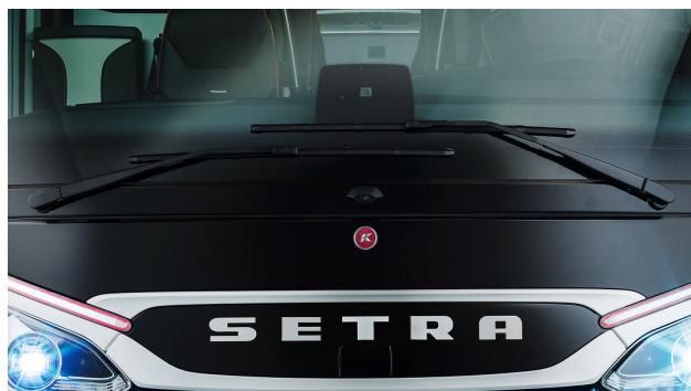
Com o seu perfil inovador, o limpa-vidros de base plana assegura que a água do limpa-vidros seja distribuída de forma particularmente uniforme no para-brisa.
