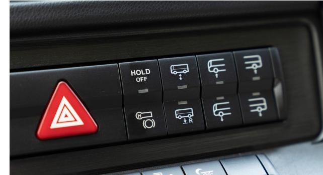
O travão eletrónico com função HOLD alia um manuseamento mais simples, mais conforto e maior segurança. Com o autocarro imobilizado, ao pressionar o pedal do travão através de um determinado ponto, o veículo é mantido parado pelo travão de serviço; ao arrancar, o travão é novamente solto automaticamente. A função pode ser desativada através de um botão.
