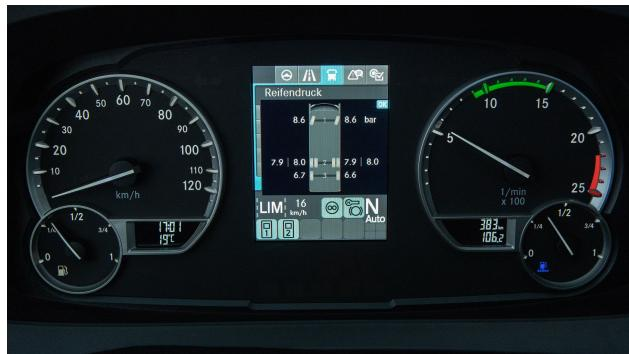
A pressão correta dos pneus contribui para a segurança de condução e para uma redução significativa do consumo de combustível. Uma pressão de enchimento dos pneus ajustada em 0,5 bar demasiado baixa pode aumentar o consumo de combustível em até 5%. O sistema eletrónico da roda está posicionado no lado interior da jante na válvula. Os sensores registam os dados relevantes para a pressão dos pneus e transmitem-nos ao instrumento indicador.
