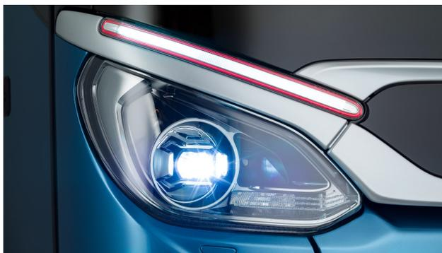
Las luces de cruce y largas tienen un gran rendimiento luminoso gracias a los faros LED integrados, que consumen además mucha menos energía que los faros convencionales. Estos faros iluminan la calzada con una gran amplitud y precisión. Otro factor que refuerza la seguridad es que la temperatura de la luz es similar a la luz diurna y provoca menos cansancio a los ojos del conductor. Los faros LED convencen por su larga vida útil y su baja degradación (pérdida gradual de la luminosidad).
