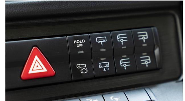
El freno electrónico con función Hold combina un manejo más fácil, mayor confort y una mayor seguridad. Con el autobús parado, al presionar el pedal de freno por encima de cierto punto, el vehículo queda retenido por el freno de servicio; al iniciar la marcha, el freno se libera de nuevo automáticamente. Esta función se puede desactivar con un pulsador.
