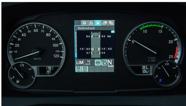
La presión correcta de los neumáticos contribuye a la seguridad de la marcha y a reducir significativamente el consumo de combustible. Basta con que la presión de los neumáticos sea 0,5 bar demasiado baja para aumentar el consumo de combustible hasta en un 5 %. La electrónica de la rueda se coloca en la cara interior de cada llanta, sobre la válvula. Los sensores registran los datos relativos a la presión de los neumáticos y los transmiten al indicador.
