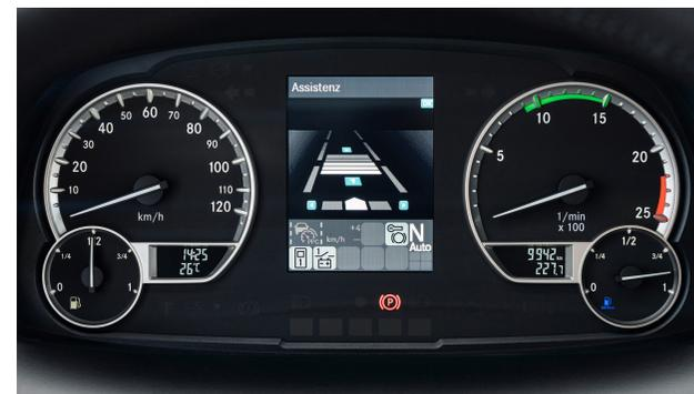
El Active Drive Assist 2 ayuda activamente al conductor a mantener la distancia y el carril mediante la combinación de distintos sistemas de asistencia. El sistema es capaz de frenar y acelerar el vehículo y mantenerlo en su carril mediante la intervención activa en la dirección. Para ello, combina de forma magistral las funciones de los distintos sistemas y hace realidad hoy una conducción semiautomatizada en todos los rangos de velocidad.
