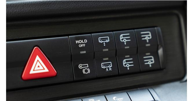
Die elektronische Bremse mit Hold-Funktion vereint einfacheres Handling, mehr Komfort und höhere Sicherheit. Bei Stillstand des Busses wird durch Drücken des Bremspedals über einen bestimmten Punkt das Fahrzeug durch die Betriebsbremse gehalten, beim Anfahren wird die Bremse automatisch wieder gelöst. Die Funktion ist durch einen Taster deaktivierbar.
