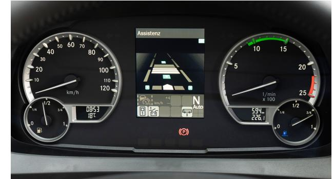
Mit Hilfe eines Kamerasystems hinter der Windschutzscheibe erkennt der Spur-Assistent SPA, wenn das Fahrzeug ungewollt die markierte Spur verlässt. Sobald das Fahrzeug die Markierungslinien überfährt, wird der Fahrer durch ein deutliches Vibrieren auf der entsprechenden Seite der Sitzfläche des Fahrersitzes gewarnt.
