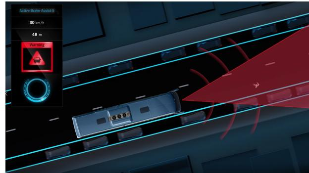
Der Notbremsassistent ABA 6 unterstützt den Fahrer durch eine automatisch eingeleitete Notbremsung bei drohender Gefahr von Auffahrunfällen auf vorausfahrende Fahrzeuge oder auf stehende Hindernisse. Er kann ebenfalls sich bewegende oder stehenbleibende Personen und Fahrradfahrer vor dem Fahrzeug erkennen. Das System kann darauf mit einer akustischen und optischen Warnung des Fahrers sowie einer automatisch eingeleiteten Teilbremsung bzw. einer Vollbremsung reagieren.
