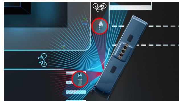
Der Sideguard Assist ist ein Sicherheits-Assistenz-System, das den Fahrer in kritischen Abbiegesituationen mit möglicherweise eingeschränkter Sicht unterstützt. Das System soll beim Abbiegen oder beim Spurwechsel dabei helfen, innerhalb der Systemgrenzen kritische Situationen zu vermeiden oder Unfallfolgen zu reduzieren.
