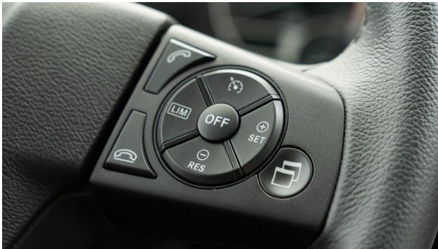
Der Abstandsregeltempomat (ART) mit Active Brake Assist 6 (ABA 6) entlastet den Fahrer, indem er auf der Basis ständiger Messungen automatisch einen gleichbleibenden, vom Fahrer definierten Abstand zum vorausfahrenden Fahrzeug einhält. Dabei unterstützt ABA 6 den Fahrer zusätzlich bei einer drohenden Kollision mit stehenden Objekten, sich bewegenden Objekten und sich bewegenden Fußgängern.
