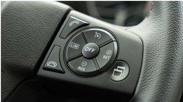
Le régulateur adaptatif de vitesse et de distance (ART) avec Active Brake Assist 6 (ABA 6) soulage le conducteur en maintenant automatiquement une distance constante définie par le conducteur par rapport au véhicule qui précède, sur la base de mesures effectuées en continu. L'ABA 6 assiste en plus le conducteur en cas de collision imminente avec des objets fixes ou mobiles et des piétons en mouvement.
