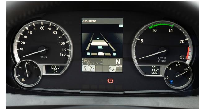
Grâce à une caméra fixée derrière le pare-brise, l'assistant de trajectoire SPA détecte si le véhicule quitte involontairement sa
