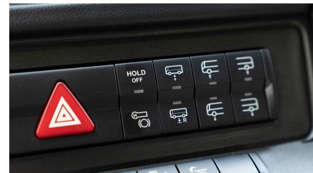
Le frein électronique avec fonction Hold allie une manipulation facilitée à plus de confort et de sécurité. Quand le véhicule est immobilisé, il est retenu par le frein de service lorsque la pédale de frein est actionnée au-delà d'un certain point ; au démarrage, le frein est à nouveau automatiquement desserré. La fonction est désactivable par un bouton.
