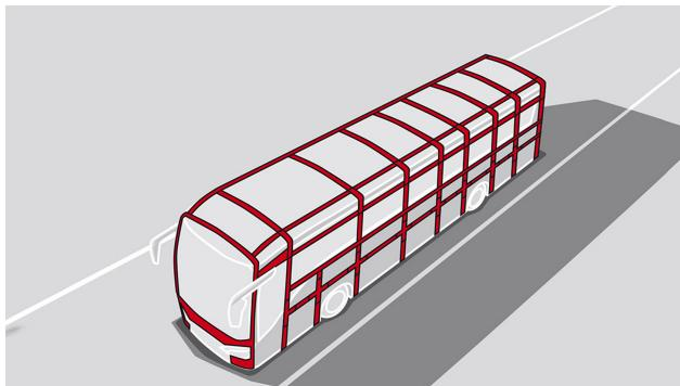
La solidité de la carrosserie est un facteur influant de manière essentielle sur la sécurité passive d'un autobus ou d'un autocar. Selon sa capacité à résister aux contraintes, elle peut en effet contribuer à réduire les conséquences d'un accident. La résistance élevée des carrosseries de nos autobus et autocars est assurée notamment par des arceaux de raidissement de construction légère sur le pourtour de la structure.
