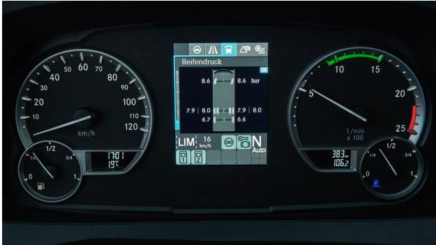
Une pression correcte des pneus contribue à la sécurité de conduite et à une réduction sensible de la consommation en carburant. Une pression des pneus trop basse de seulement 0,5 bar peut déjà générer une hausse de la consommation de carburant pouvant s'élever jusqu'à 5 %. L'électronique de roue est positionnée à chaque fois en face intérieure de la jante sur la valve. Les capteurs saisissent les données requises pour établir la pression des pneus et les transmettent à l'instrument d'affichage.
