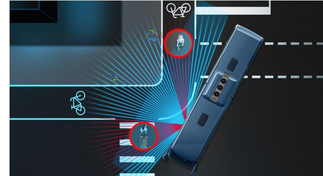
Le Sideguard Assist est un système d'assistance et de sécurité qui aide le conducteur dans les situations de changement de direction critiques où la visibilité est potentiellement restreinte. Le système a vocation, lors des changements de direction ou de voie, à éviter (dans les limites du système) les situations critiques ou à réduire les conséquences des accidents.
