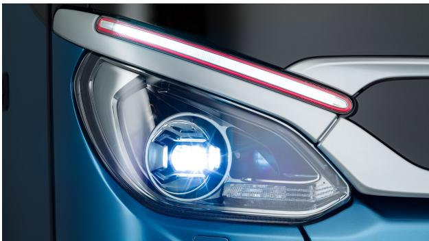
Abblend- und Fernlicht profitieren von der hervorragenden Lichtausbeute der Integral-LED-Scheinwerfer, die gegenüber dem Standardlicht zudem mit deutlich weniger Energie auskommen. Sie leuchten die Fahrbahn breit und präzise aus. Ein weiterer Sicherheitsgewinn ist die Licht-Temperatur, die der von Tageslicht ähnlich ist und die Augen weniger schnell ermüden lässt. Die LED-Leuchten überzeugen durch eine lange Lebensdauer und geringe Degradation (Nachlassen der Leuchtkraft).
