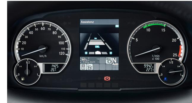
Der Active Drive Assist 2 unterstützt den Fahrer durch die Kombination verschiedener Assistenzsysteme aktiv beim Abstand- und Spurhalten. Das System kann das Fahrzeug bremsen, beschleunigen und durch aktive Lenkbewegungen in der Spur halten. Dazu verbindet er die Funktionen der einzelnen Systeme auf einzigartige Weise und ermöglicht so bereits heute teilautomatisiertes Fahren in allen Geschwindigkeitsbereichen.
