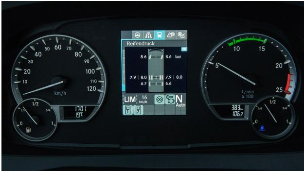
Der richtige Reifenfülldruck trägt zur Fahrsicherheit und deutlich reduzierten Kraftstoffverbrauch bei. Bereits ein um 0,5 bar zu niedrig eingestellter Reifenfülldruck kann den Kraftstoffverbrauch um bis zu 5% erhöhen. Die Radelektronik ist jeweils an der Innenseite der Felge auf dem Ventil positioniert. Die Sensoren erfassen die für den Reifendruck relevanten Daten und leiten sie an das Anzeigegerät weiter.
